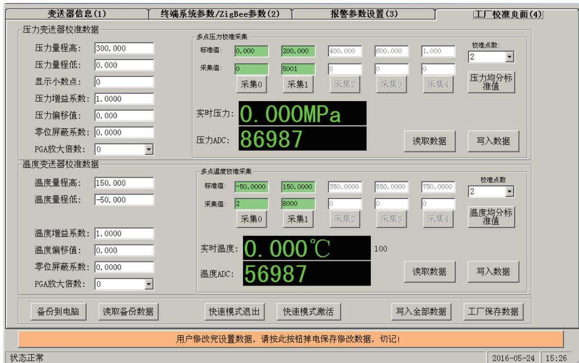
工厂校准页面主要是温度和压力的校准数据，此为工厂数据。工厂数据参数意义以及设置详细情况咨询常州天利，这里不做太多解释。需要特别说明的是本公司采用多点数据拟合算法，保证压力和温度传感器的数据准确性。可以根据变送器的类型，选择校准温度还是压力通道。工厂数据采集完毕需要写入操作，然后需要执行工厂保存操作数据才会被永久保存在变送器内部。
