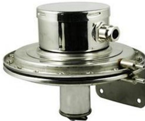
控制器采用膜片式传感器，可用于气体、液体等介质。控制器的设定值可调，调节范围10~2500Pa。工作压力范围0~0.1MPa。传感器金属材质采用镀锌钢和不锈钢两种材料，以适合不同用户的需求。
