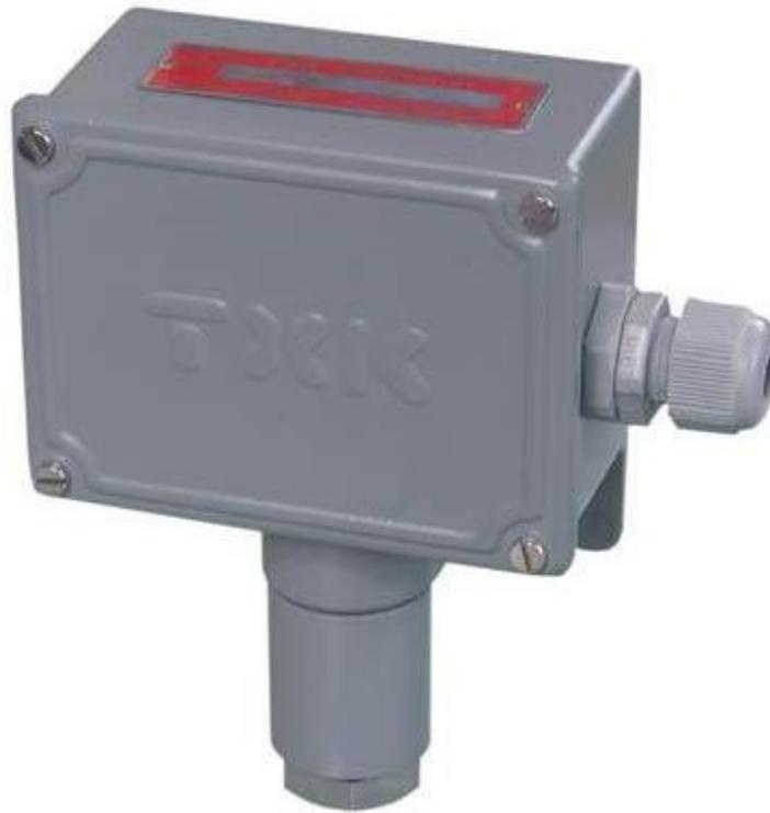
该压力控制器可在恶劣现场安装，控制器的压力敏感元件为力平衡，活塞动作的装置。敏感元件通过一柔性膜片和一静态 O 型密封。
