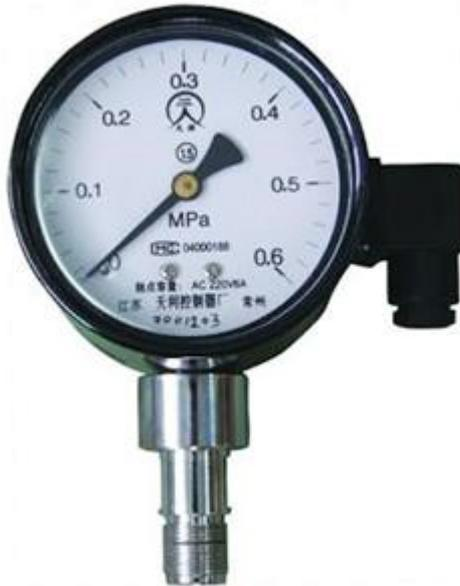
YTK-18-I 型带指示压力控制器用于压缩机、高压开关、电厂、锅炉、火车、轮船以及制冷设备中心的自动控制，以及过程中的报警、保护等，并且是电接点压力表理想的换代产品。YTK-18-I 型压力控制器采用波纹管式的传感器，可用于空气、气体、水蒸气等中性气体和水、制冷剂、油等介质。控制器的设定值可调，调节范围为-0.1~6MPa。
