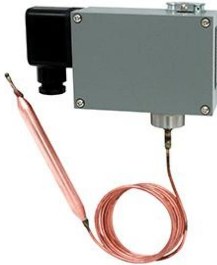
控制器采用毛细管温包式传感器，可用于流动的中性气体和液体介质。如果介质为腐蚀性，安装时可选用不锈钢温包保护套套在铜质温包外，控制器的设定值可调，调节范围-30~280℃。
