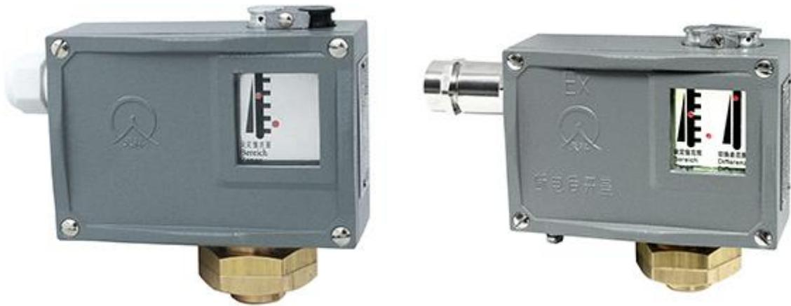
控制器采用膜片式传感器，可用于空气等中性气体和水、液压油、润滑油、轻燃油等液体介质。控制器的设定值可调，调节范围 0~2.5MPa。
