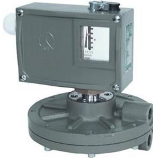
控制器采用膜片式的传感器，可用于中性油、气介质和水。控制器的设定值可调，调节范围0.2~25KPa，工作压力范围0~0.16MPa。
