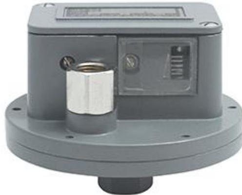
控制器采用膜片式传感器，可用于中性气体、液体介质。控制器的设定值可调，调节范围 0.1~25KPa，工作压力范围 0~50KPa。
