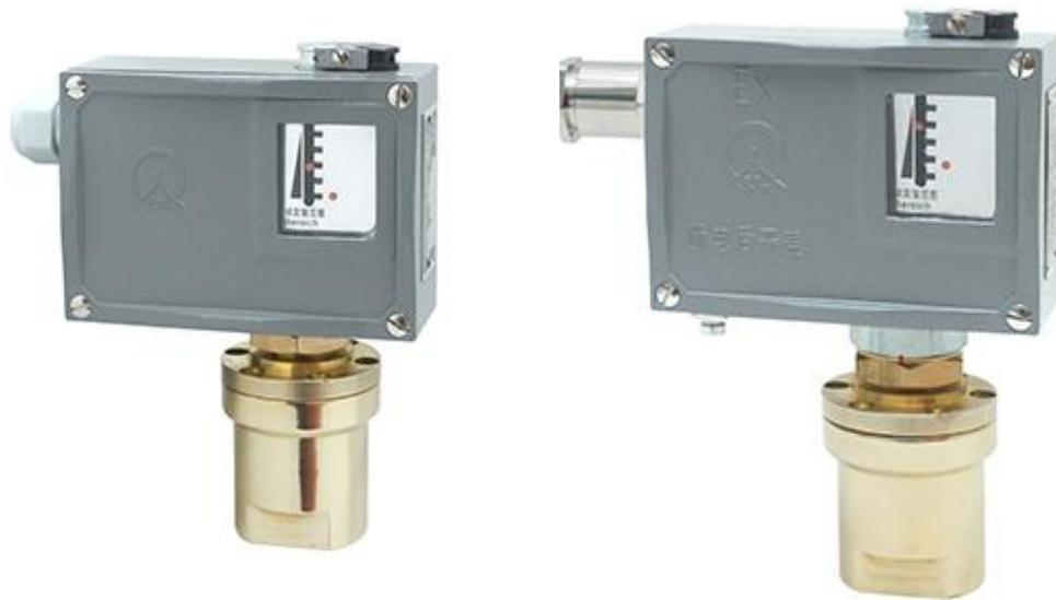
控制器采用波纹管式的传感器，可用于空气、气体、水蒸汽等中性气体和水、制冷剂、油等液体介质。控制器的设定值可调，调节范围 0.02~1.6MPa, 工作压力范围 0.05~2.5MPa。
