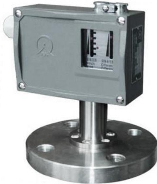
控制器采用法兰膜片式传感器,可用于腐蚀性或粘性流体介质以及含有粉尘物或易结晶物的介质,控制器的设定值可调,调节范围0.02~0.6MPa。
