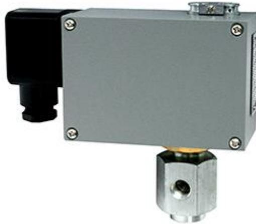
控制器采用带泄油口的活塞式传感器，可用于中性液压油等介质。控制器的设定值可调，调节范围 0.3~40MPa。
