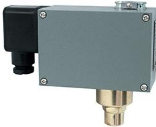
控制器采用波纹管式的传感器，可用于中性气体、液体介质。控制器的设定值可调，调节范围 0.1~2.5MPa。
