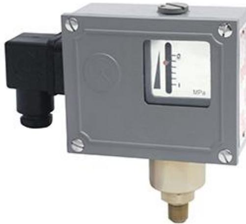
502/7D-C 型压力控制器采用波纹管式传感器，可用于空气、气体、水等中性气体和润滑油、轻燃油等液体介质。控制器设定值可调，调节范围为-0.1~4MPa，控制器均采用铸铝壳体，为防水型，满足船用条件。
